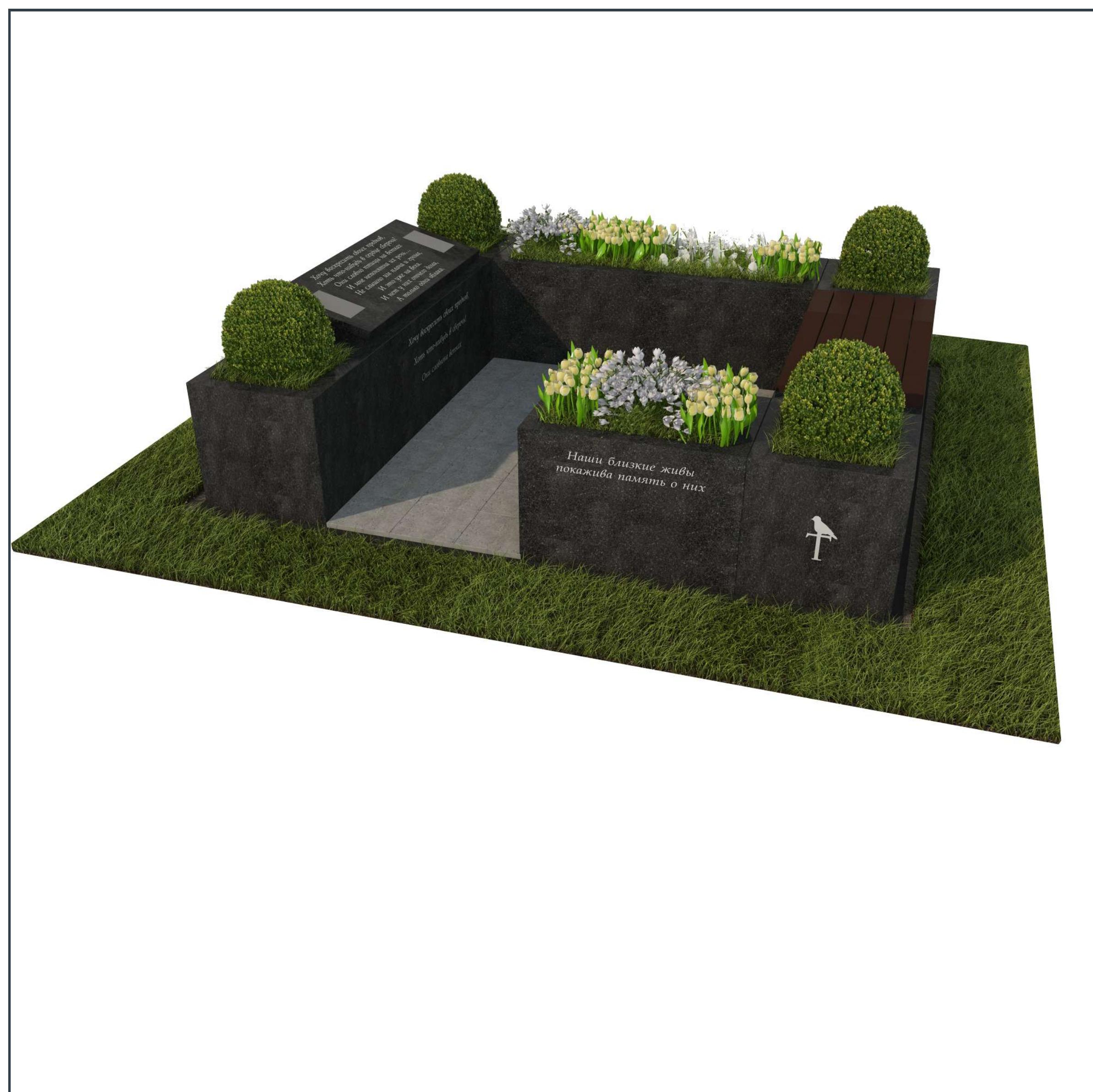
Для эстетичности и большей долговечности данная конструкция предусматривает расположение фундамента чуть ниже уровня грунта. В случае если участок имеет большой уклон и появляются выступающие над землей части фундамента, их необходимо обработать битумом холодного применения с помощью валика или предусмотреть облицовку.
